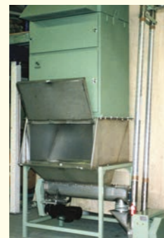
Alimentación de transportador vertical desde estación de vertido de bolsas con salida de alimentador helicoidal y sistema integral de extracción de polvo.
