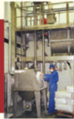
Manuelle Sackentleerung in den Mischer unter Verwendung eines Vertikalförderers und eingebauter Dosierschnecke.
