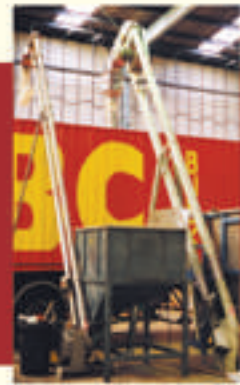
M100 und M125 Zuführung ISO-Behälter mit Kunststoffgranulaten.
