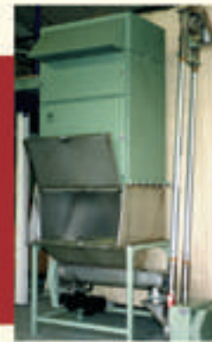
Vertikalförderer Zuführung von Sackentleerungshaube mit Dosierschneckenabgabe und eingebautem Staubabsaugsystem.
